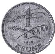
Laminering som følge af urenheder i det udvalgte blanketmateriale. Øverst norsk 2 skilling 1810 og nederst dansk 1 krone 1946.
