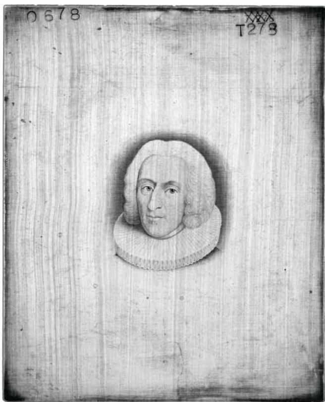
Fig.5 Trykplader af stål med portrætter anvendt til udvikling af nødbereidskabet i Nationalbankens seddeltrykkeri. Hver plade er ca. 10 × 12,5 × 0,5 cm.
