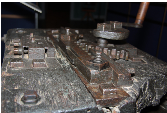
Fig. 4. Randværk fra Mønten i Kongsberg. I den type randværk blev møntblanketteres rand dekoreret med mønstre eller skrift, når blanketterne blev tvunget imod randværkets bakker, der var graverede stykker stål. Norsk Bergverksmuseum. Foto: Frode Sæland og Christian Berg.
