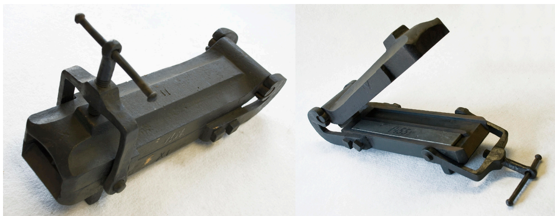
Fig. 2. Jernstøbeform/ingusser til støbning af to tene fra Mønten i København før 1889, Danmarks Tekniske Museum. Mønten i Stockholm anvendte tilsyneladende de bedre jernstøbeforme tidligere end Mønterne i Altona, København og Kongsberg. Se mere i Märcher 2012, 90-98.
